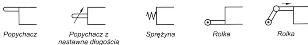
Rys. 24. Sposoby oznaczania mechanicznego sterowania zaworem rozdzielającym [2]
