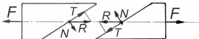
Rys. 4.33. Naprężenia styczne oraz normalne
