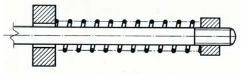
Rys. 4.42. Sprężyna jako element konstrukcyjny [1]
