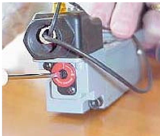
Rys. 4.5.7. Ręczne ustawianie umożliwia sterowanie elektrozaworem bez włączania zasilania [3]
