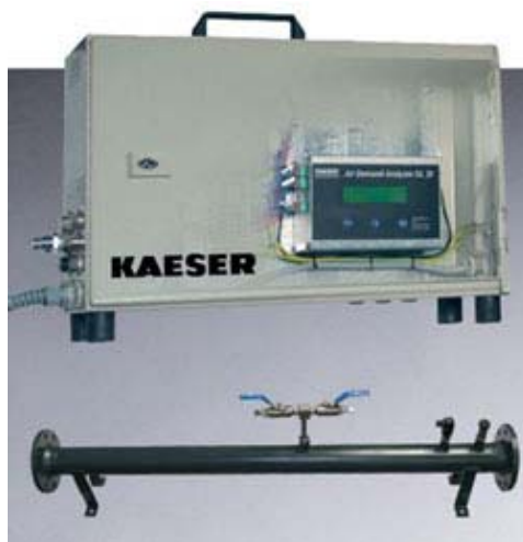
Rys. 4.5.3. Przyrząd do kontroli poboru sprężonego powietrza. Przepływ mierzony jest metodą pomiaru różnicy ciśnień za pomocą odcinka pomiarowego, instalowanego na sieci [3]
